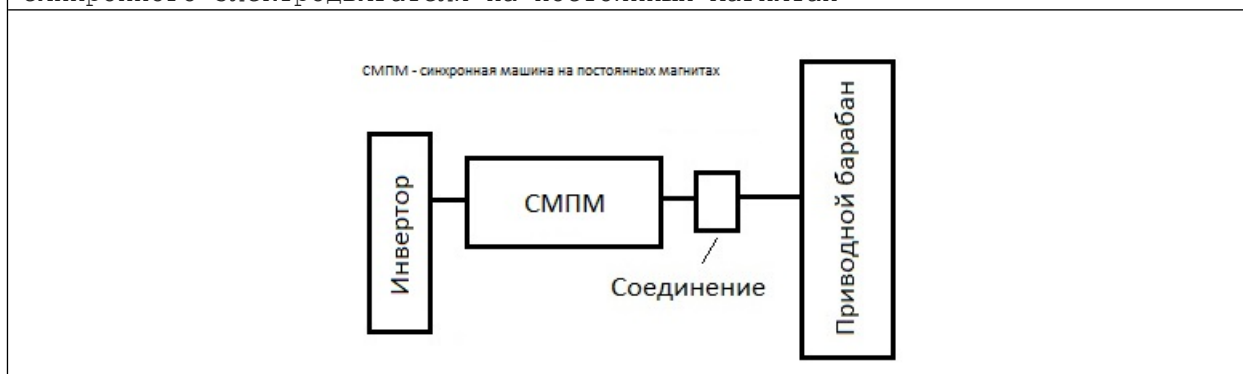
Рис.3 Схема привода ленточного конвейера на основе частотно-регулируемого синхронного электродвигателя на постоянных магнитах
